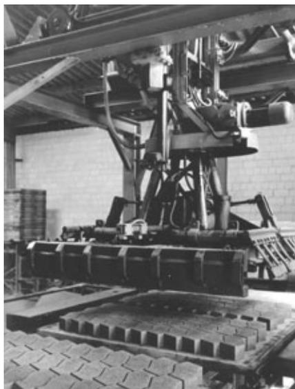
Erstes vollautomatisches Paketiergerät aus dem Jahre 1966
